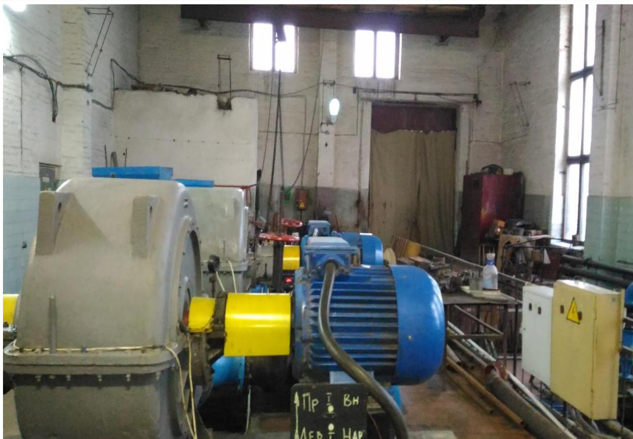
**Рисунок 54 Турбокомпрессоры**
