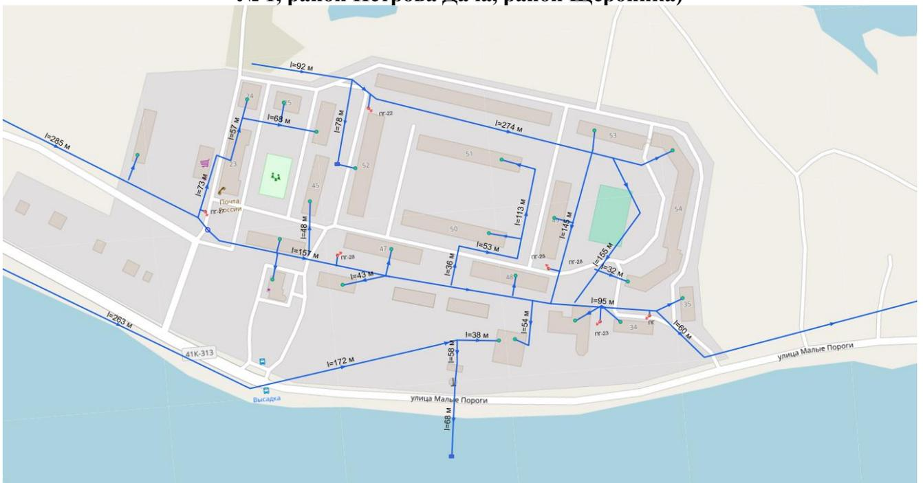
**Рисунок 25** Централизованная система водоснабжения в пгт. им. Свердлова (микрорайон № 2)
